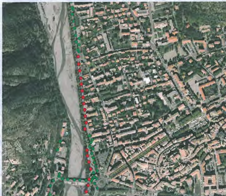
Zone 1 : Point rouge : point lumineux modifié – Point vert : point lumineux conservé
