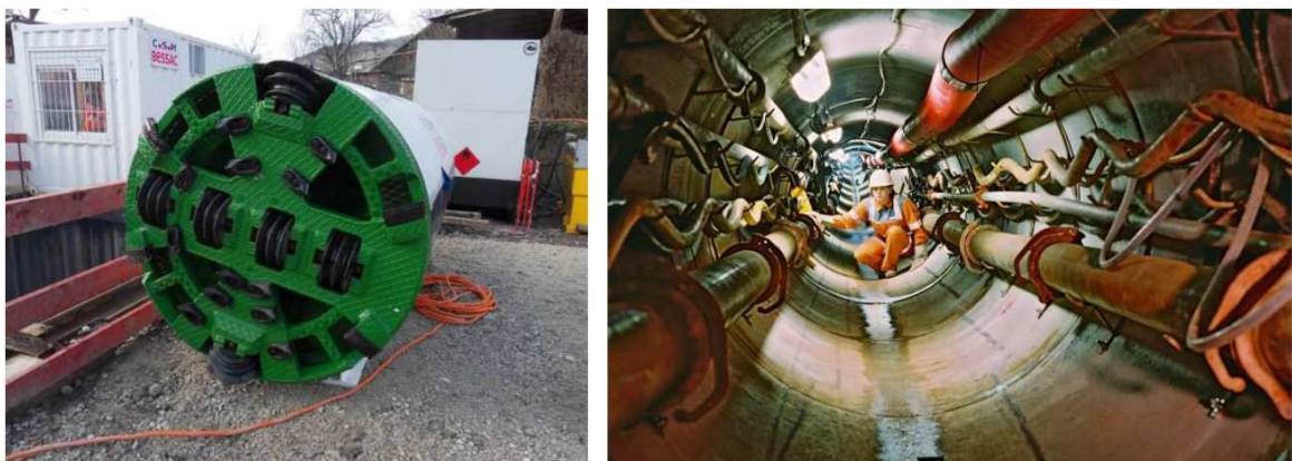
Figure 43 : Tête de forage et micro-tunnelier DN 1200 (source : BESSAC)
