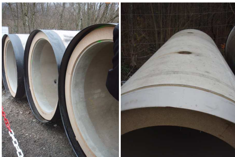
Figure 44 : Voussoirs de micro-tunnelier (source : SAGE)
