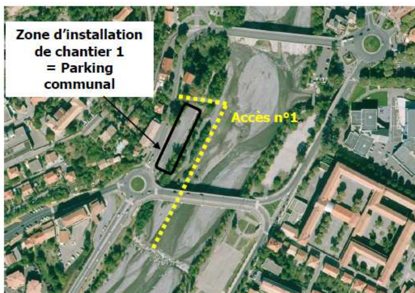
Figure 21 : Accès et installation de chantier pour les travaux du seuil du pont Beau de Rochas
