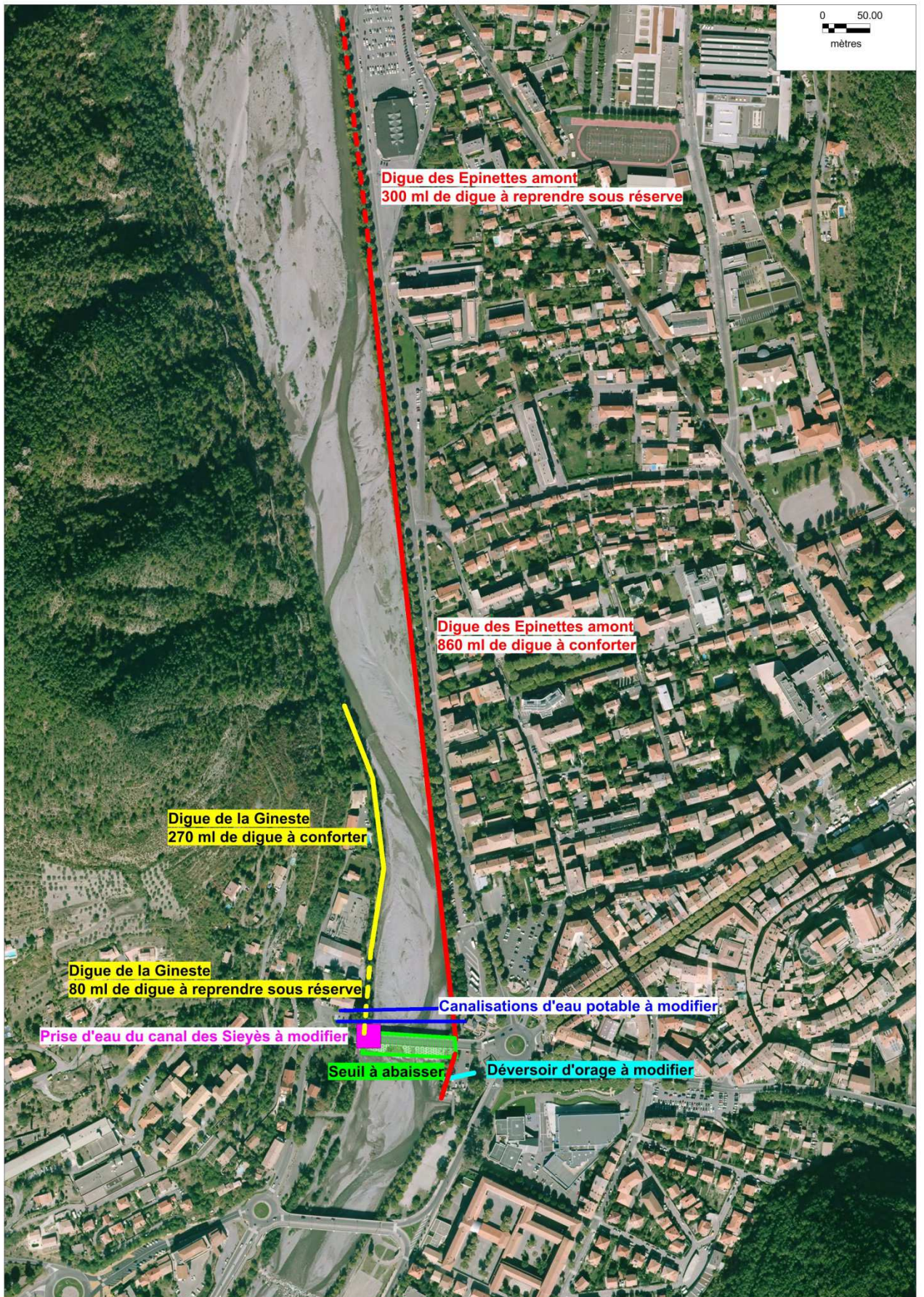
Figure 3 : Localisation des travaux prévus dans le cadre de l'aménagement du seuil du Grand Pont sur la Bléone
