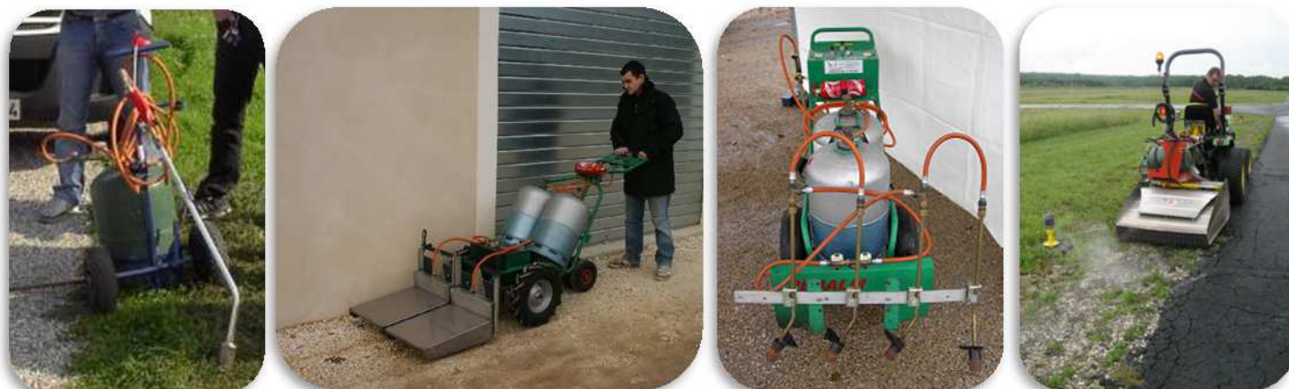
Désherbeurs thermiques à flamme directe (lance simple), à infrarouge et désherbeur thermique à flamme directe (rampe 4 brûleurs), four porté sur véhicule
