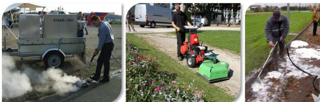
De gauche à droite : Désherbeurs thermiques à vapeur chaude, à air chaud et à mousse chaude
