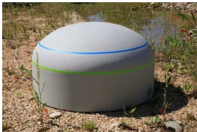
Photo 1 : Prototype des plots de la future passe à poissons au niveau du pont Batelier
