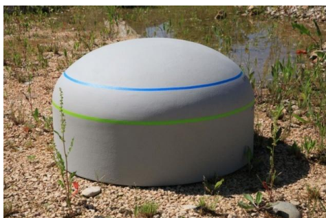
Photo 7 : Prototype des plots de la future passe à poissons au niveau du pont Batelier
