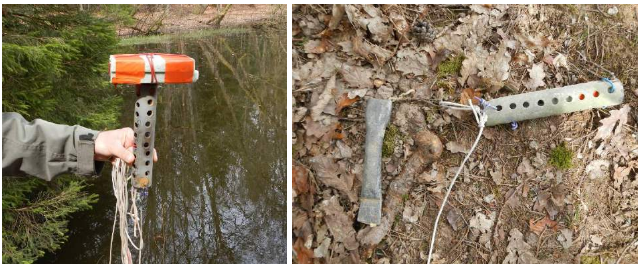
Photographie 18 : dispositif pour sonde de surface (à gauche) et pour sonde de fond (à droite).
