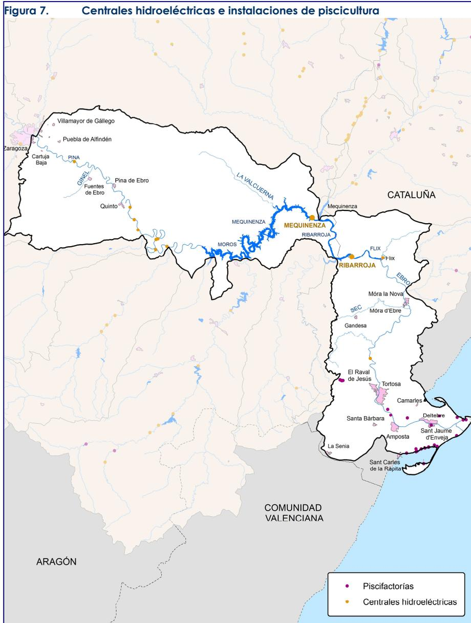
El sistema cuenta con 11 centrales hidroeléctricas en funcionamiento que se muestran en la Tabla 17. Estas centrales tienen capacidad para turbinar más de 3.565 m<sup>3</sup>/s, con una potencia instalada de 699 MW y una producción agregada estimada de 2.232 GW/h. Las centrales más destacadas son las de Mequinenza y Ribarroja.
