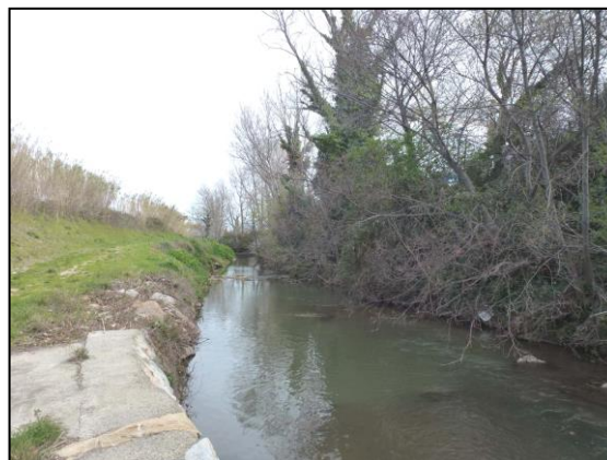
secteur urbain de Toulouges avec de fréquentes berges instables à revégétaliser par des techniques végétales en pied de talus.
