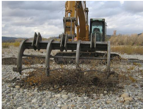
Figure 2 : exemple d'outil utilisé sur le Durance pour essarter les bancs
