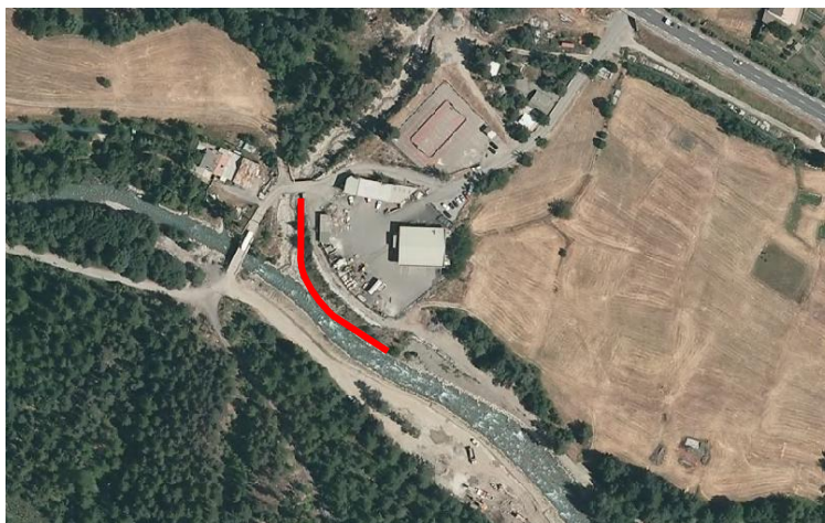
Fig. 111. Protections de berges à mettre en place au droit de la confluence
