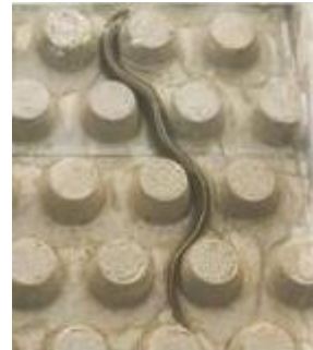
Figure 59 : Exemple d'une anguille progressant entre les plots d'une dalle Evergreen
