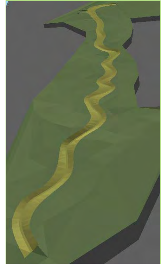
Vue 3D du nouveau lit de la Mouge
