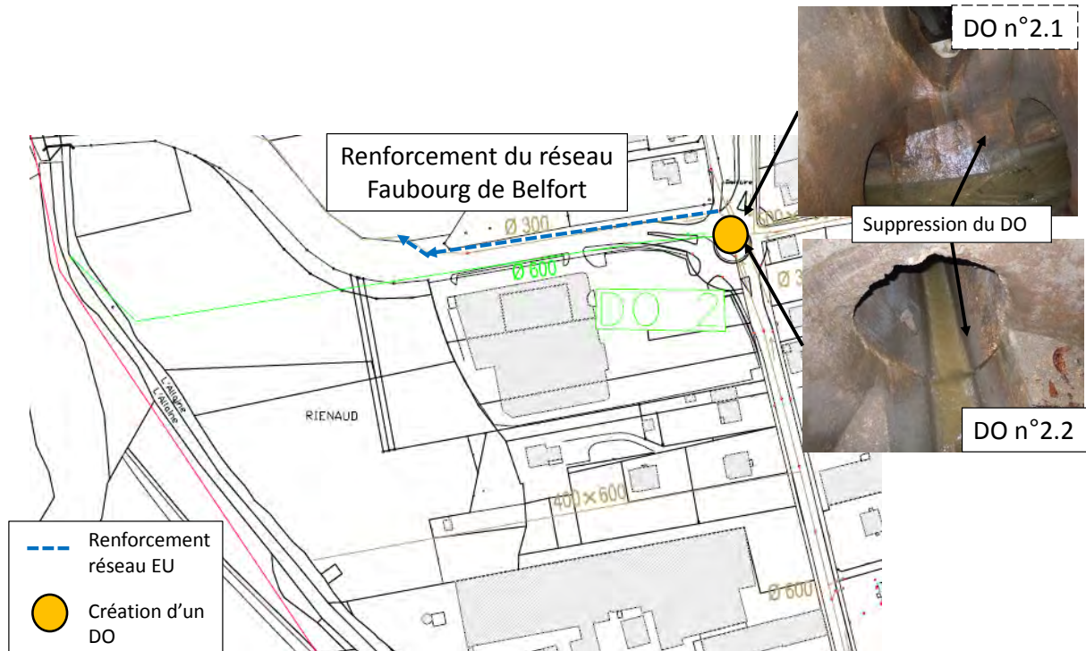
Figure 11 : Travaux de création de bassin d'orage et de renforcement de réseau Faubourg de Belfort
