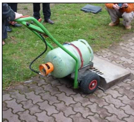
Désherbeur thermique par émission infrarouge
