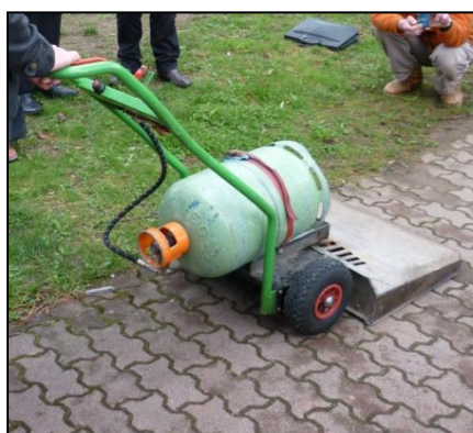
Désherbeur thermique par émission infrarouge
