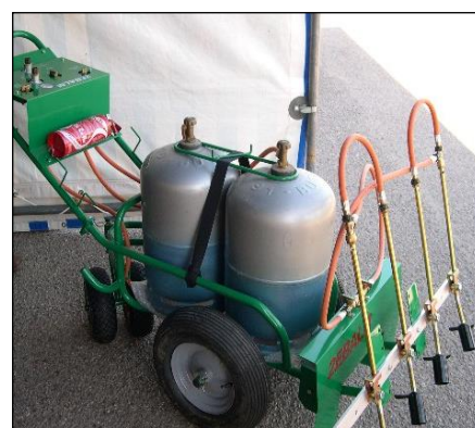
Désherbeur thermique à flammes directes à quatre buses
