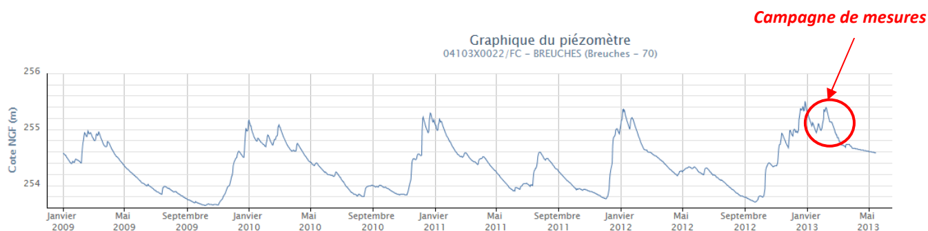
Figure 6 : Graphique du relevé piézométrique le plus proche - Source : ADES 2013
