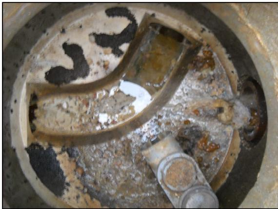
Photo 13 : concrétions calcaires (FILL 0933)
