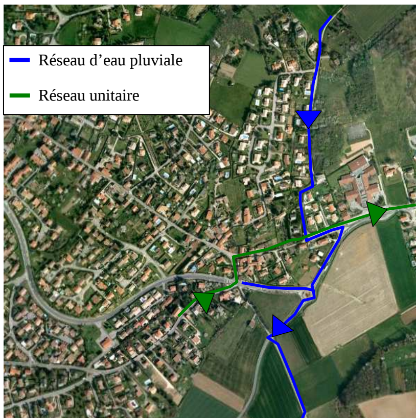
Figure 3-15 : Vue aérienne des axes principaux de ruissellement du bassin de collecte d'eaux pluviales du quartier de Villeneuve Est
