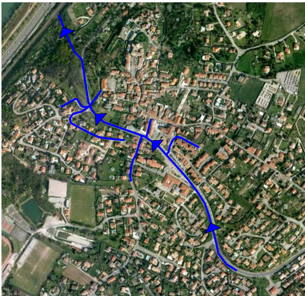
Figure 3-6 : Vue aérienne des axes principaux de ruissellement du bassin de collecte de la rue Neuve
