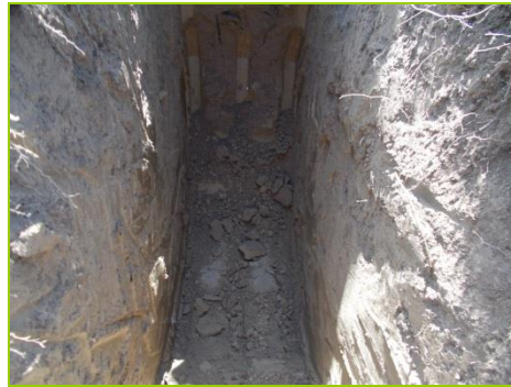
Figure 31 : Traces d'hydromorphie dans le secteur de la STEP du village de La Bréole
