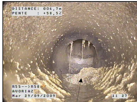
R.58 à R.55 : Dépôts durs et compacts
