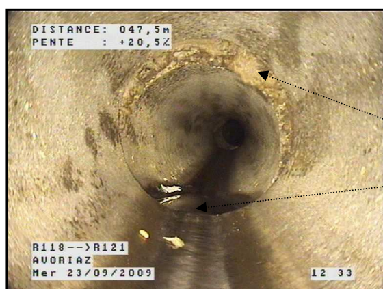
R.121 à R.118 : Fissure circonférentielle ouverte
