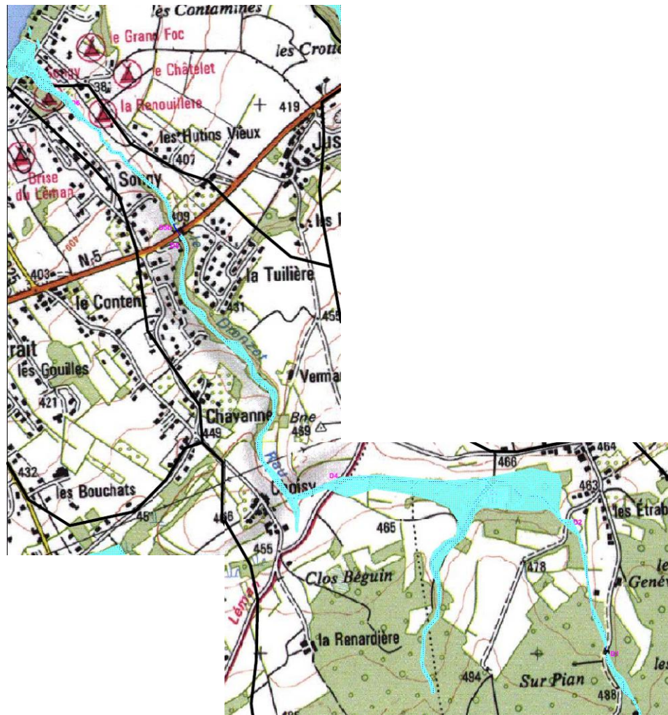
Figure 44 : Cartographie des zones inondables du Dronzet pour la crue centennale (Zones inondables en bleu) (Source : Hydretudes, 2004)
