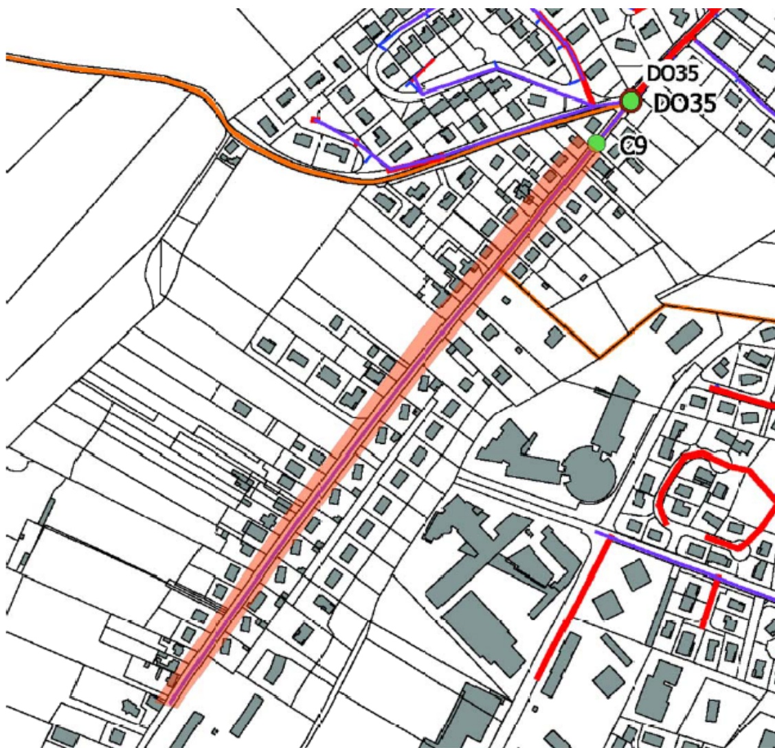
Figure 65 : Synthèse des résultats de localisation des ECP sur Chavanoz Est, amont DO35
