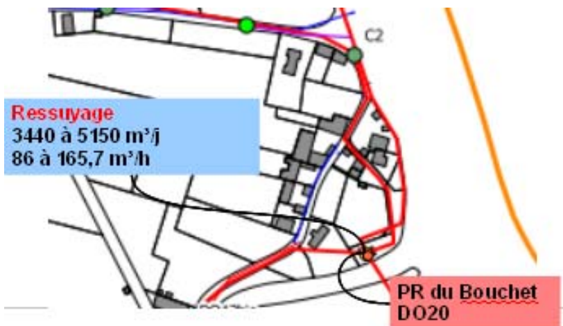
Figure 62 : Synthèse des résultats de mesures sur PR du Bouchet
