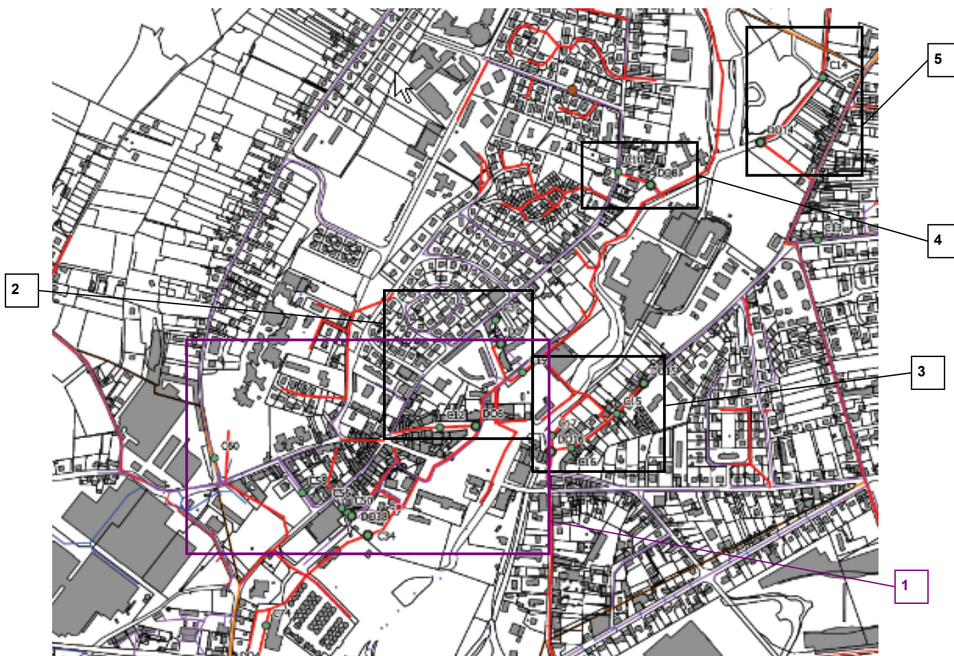
Figure 46 : Schéma de la collecte sur Pont-de-Chéry
