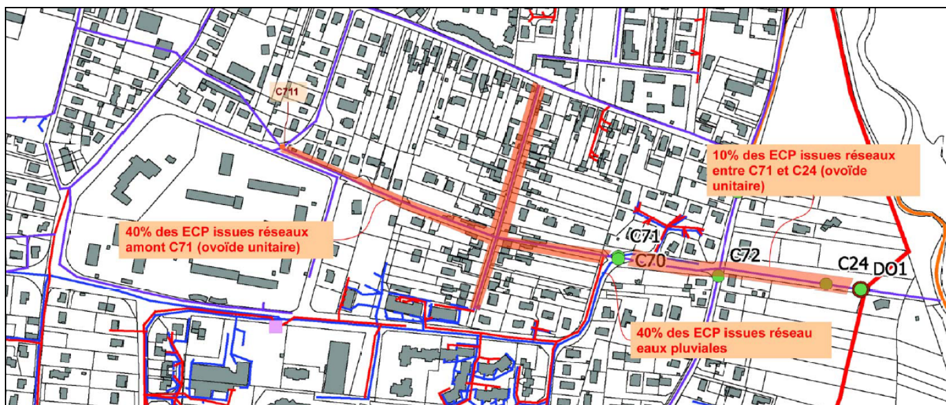
Figure 34 : Synthèse des résultats de localisation des ECP sur la Rue des Allobroges
