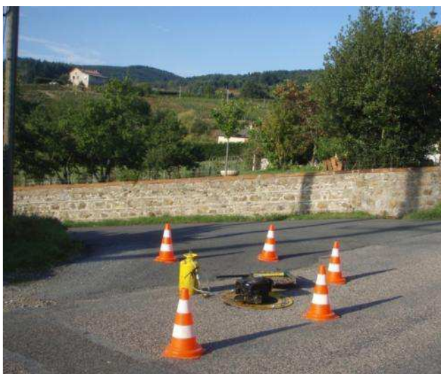
1 - injection de fumée dans le réseau d'eaux usées
