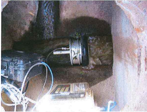
Débitmètre type SIGMA 950 « bulle à bulle » avec manchon déversoir
