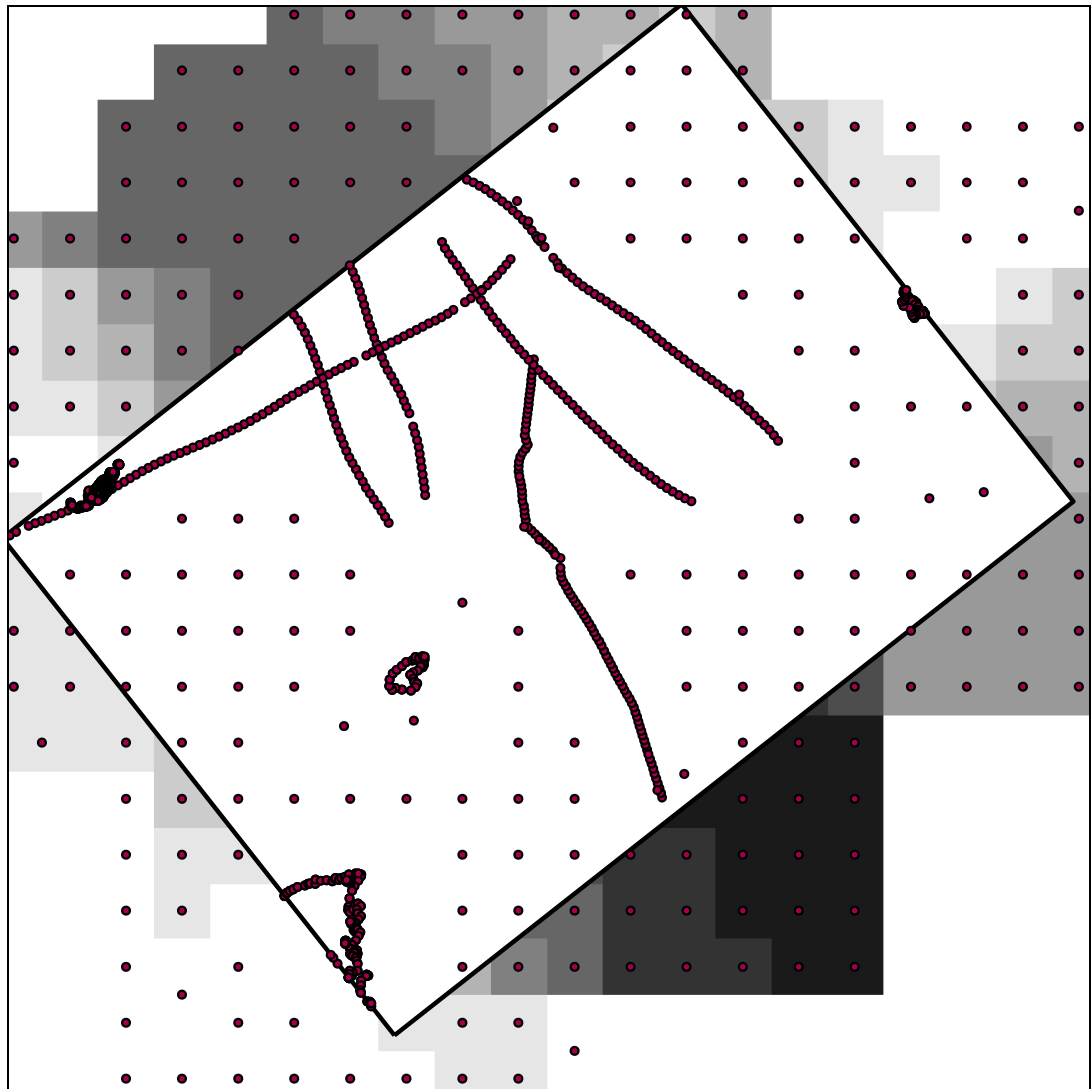
Illustration 25. Grille des cotes du mur des dépôts cénozoïques de couverture, calculée par interpolation « régionale » des mesures sur les puits pétroliers de la zone d'étude, des cotes à l'affleurement et des valeurs évaluées par conversion des temps sismiques en profondeurs. Localisation des points de calage et des points de contrainte dérivés pris en compte dans le modèle optimal.
