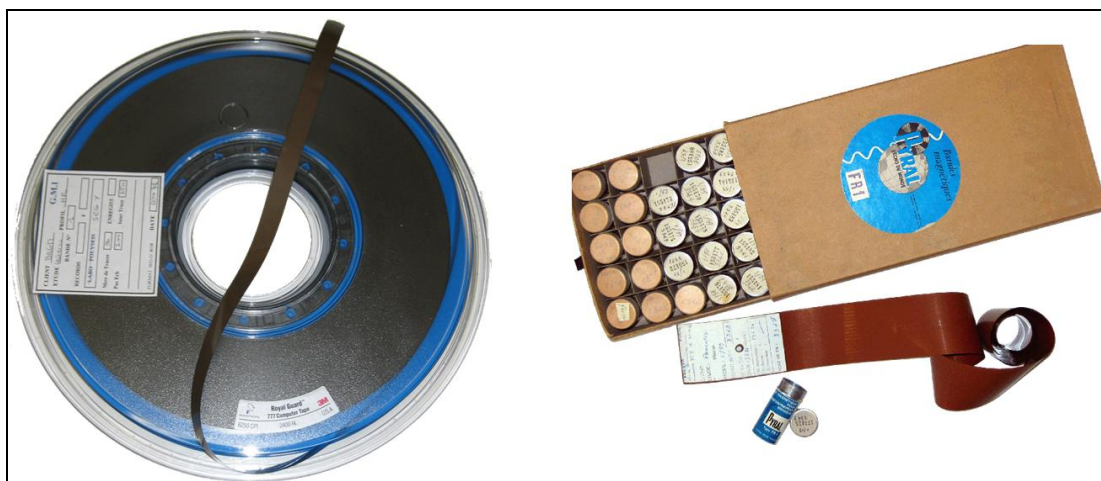
Illustration 9. Supports d'enregistrement sur le terrain, magnétique à gauche et bande carter à droite.
