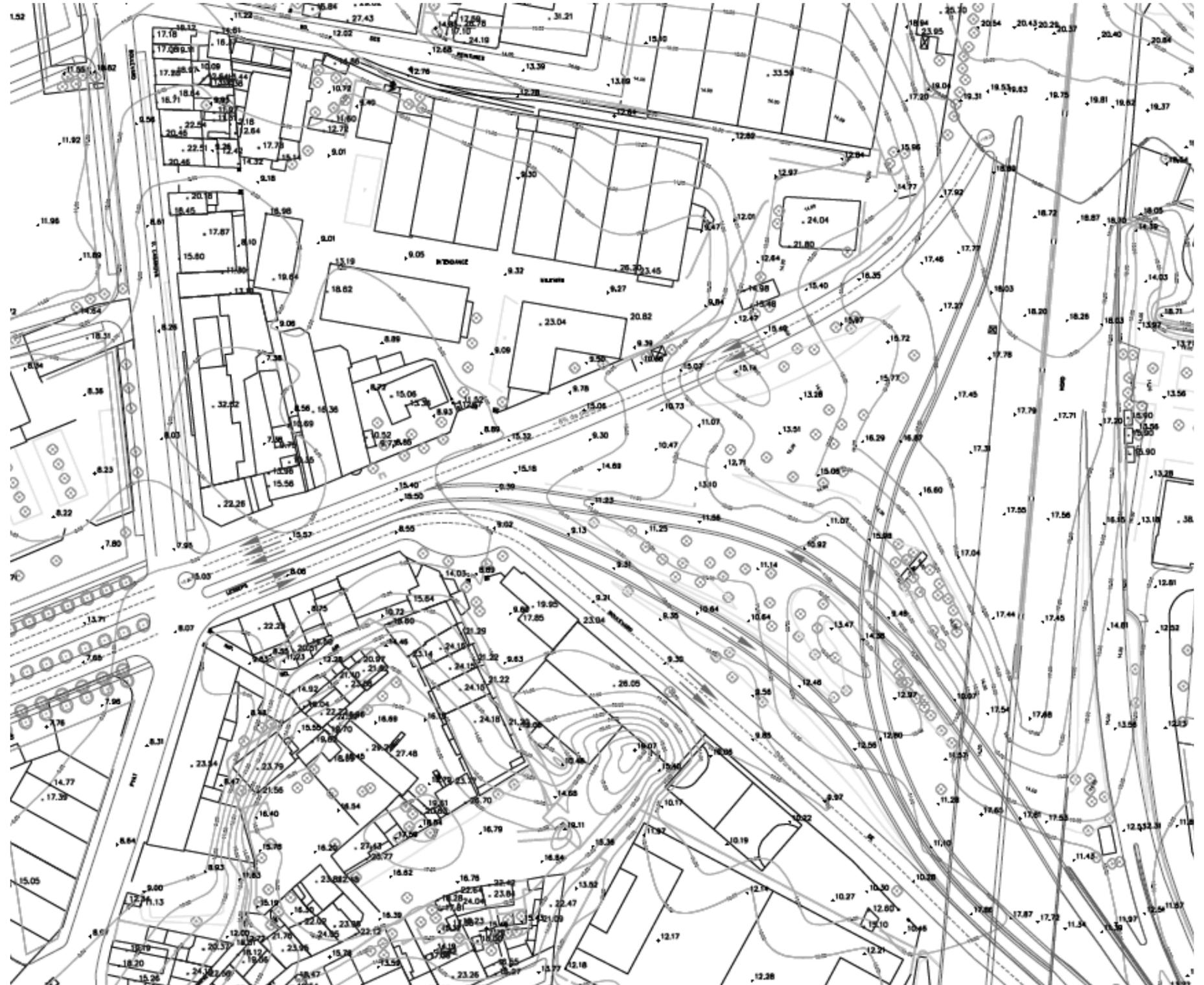
Remarque : bien que l'insertion de l'échangeur ait ici été étudiée à 3 voies sur Lesseps, l'analyse du trafic attendu nous pousse à préconiser quatre voies sur le bd de Lesseps (élargissement à 2 voies de la bretelle Plombières -> Lesseps) pour éviter notamment des remontées de files inacceptables sur A7.
