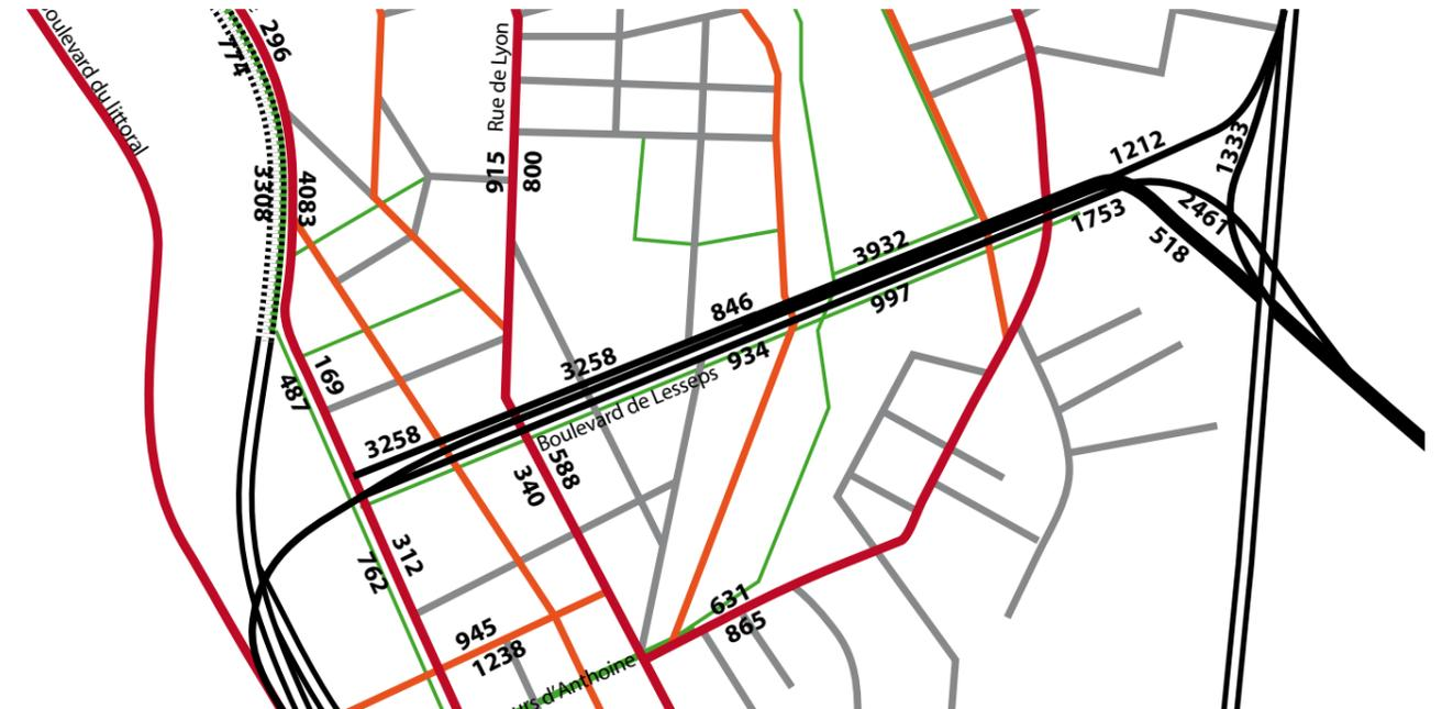
Figure 2.1 : détail de la modélisation du trafic (en uvp) à l'horizon 2020 en HPM
