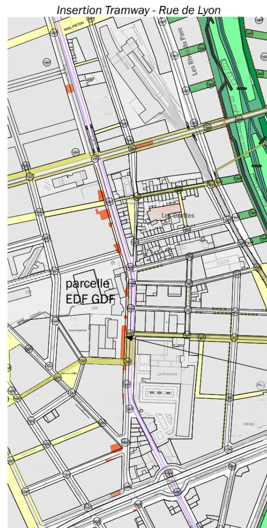
Impact de l'insertion du TCSP sur la rue de Lyon sur l'emprise GDF et les bâtiments à l'alignement de la rue, recul de 3 à 4 m.
