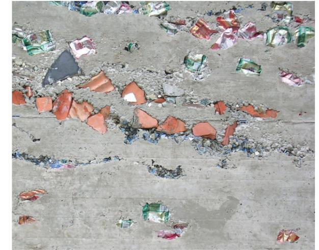
béton avec éléments recyclés insérés
