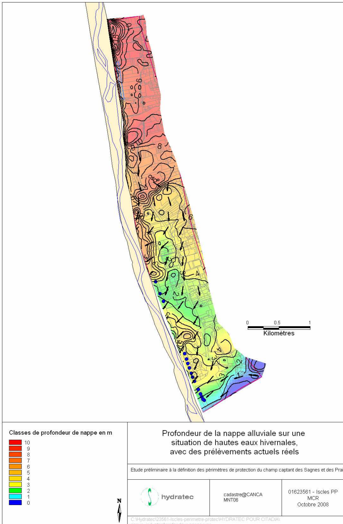
Figure 23 : Profondeur de la nappe alluviale sur une situation de hautes eaux hivernales avec des prélèvements réels de l'année 2006 - 2007
