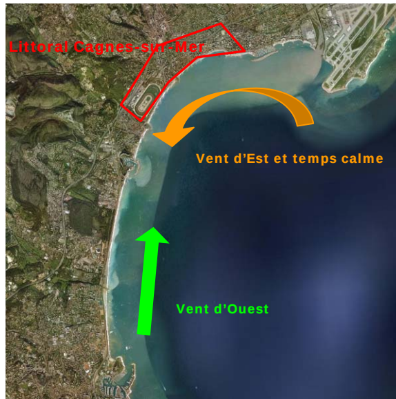
Figure 4 : schéma simplifié de la circulation des courants sur le littoral de Cagnes-sur-mer
