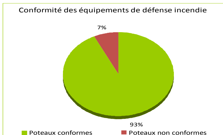
Figure 11 : Conformité des équipements de défense incendie vis-à-vis du débit fourni
