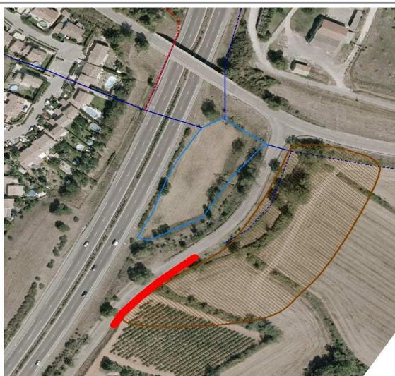
Création d'un merlon le long de la voie communale à la cote 334 m NGF, au niveau du point pas de cette cuvette naturelle. Cet aménagement est accompagné de la mise en place d'un ouvrage de régulation ( $\Phi 700$ ) avec surverse dans l'ouvrage existant. Il permet ainsi le stockage des eaux de pluie, sur une zone utilisée (agriculture), jusqu'à 6 000 m<sup>3</sup>.
