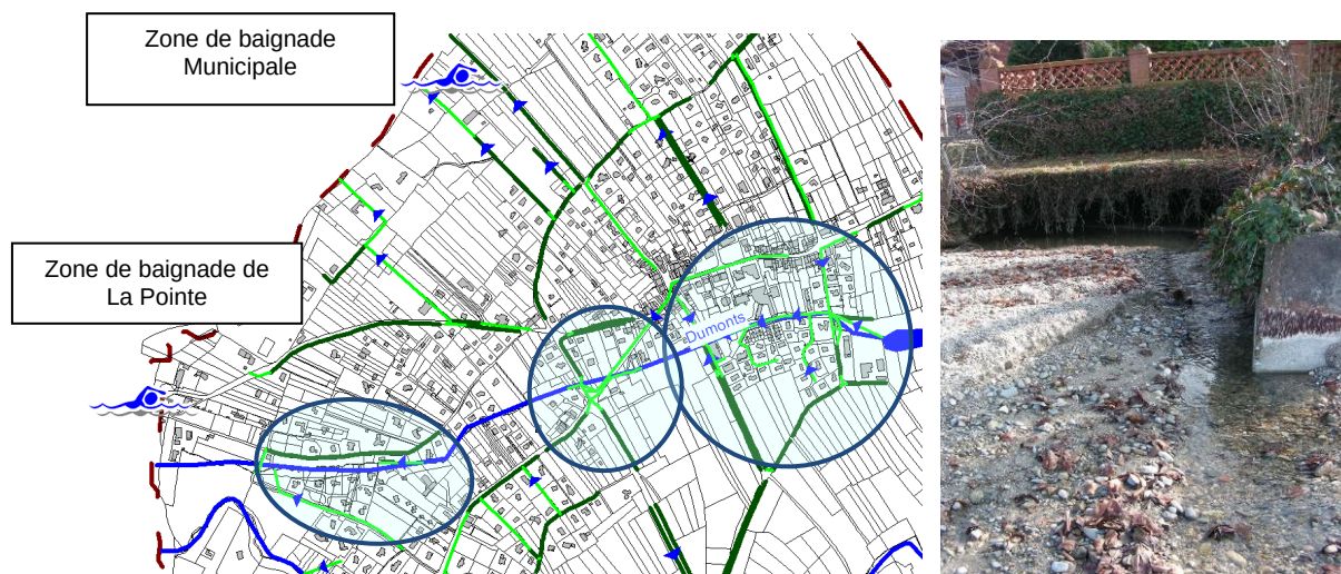
Figure 54 : Réseau des eaux pluviales dans le secteur du ruisseau des Dumonts (à gauche) et exutoire du ruisseau des Dumonts en limite de la zone de baignade de La Pointe (Source: photo CIDEE)
