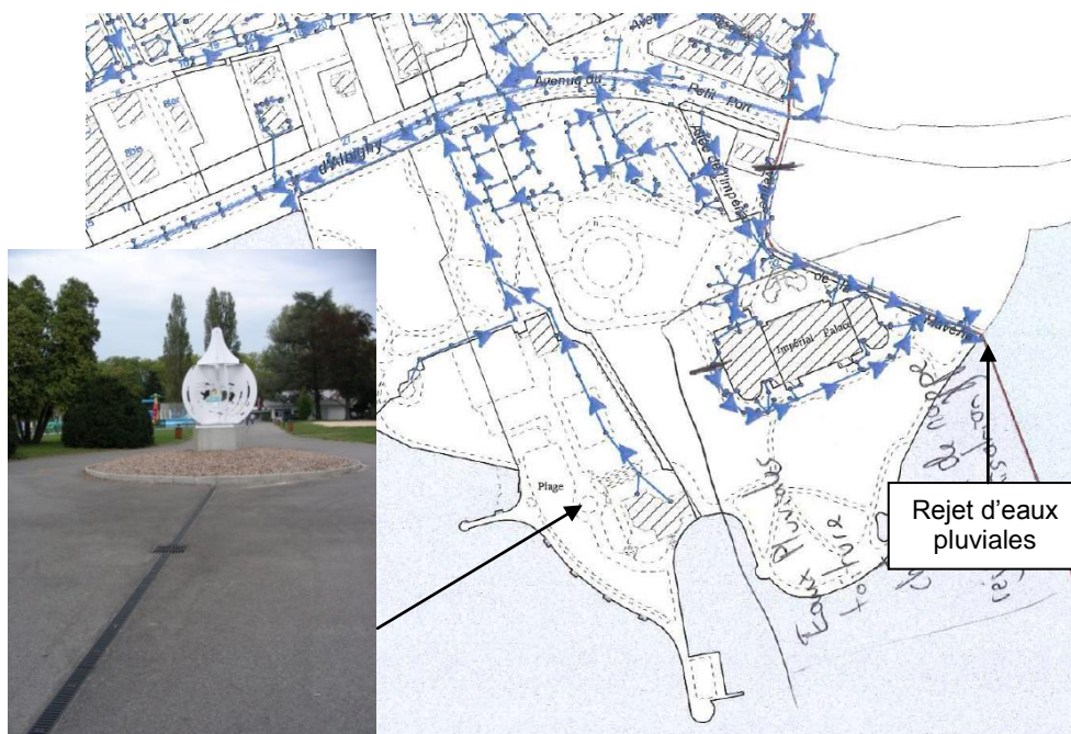
Figure 38 : Réseau des eaux pluviales à proximité de la zone de baignade de l'Impérial (Source: Commune d'Annecy)
