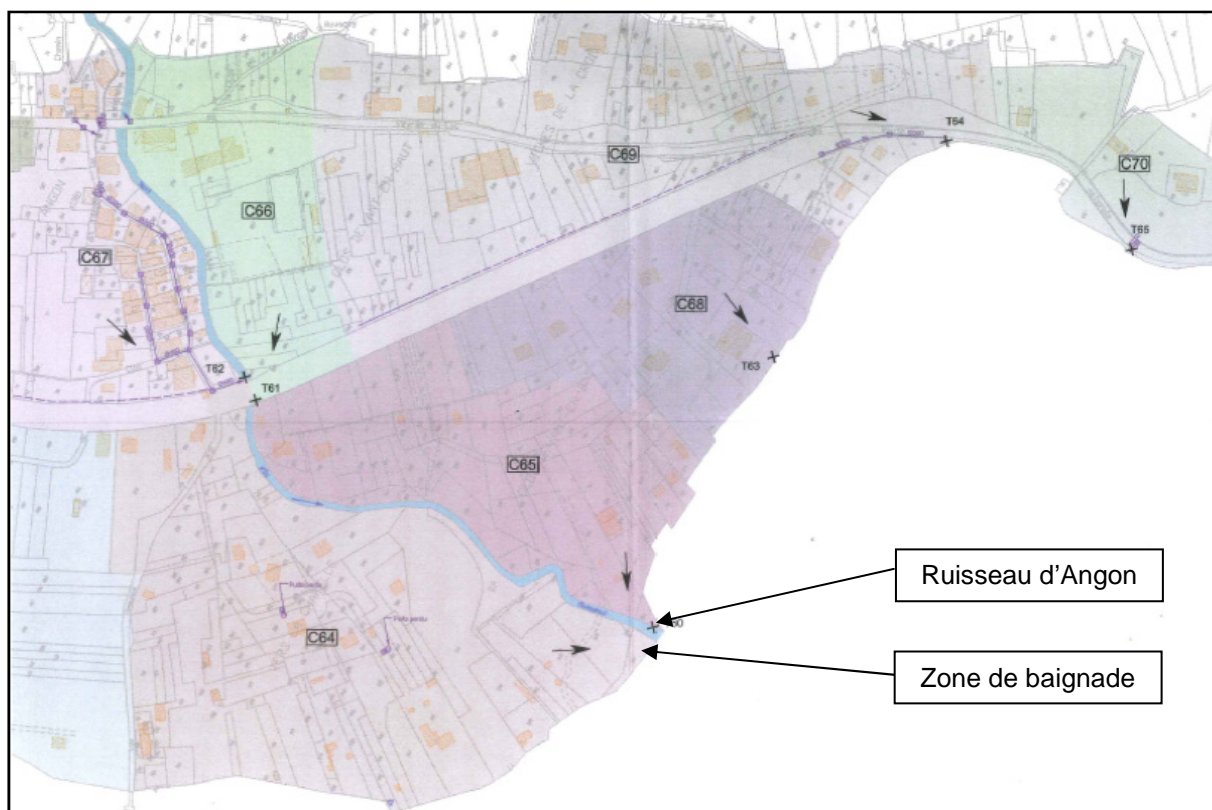
Figure 32 : Réseau des eaux pluviales à proximité de la plage d'Angon (Source: Communauté de communes de la Tournette)
