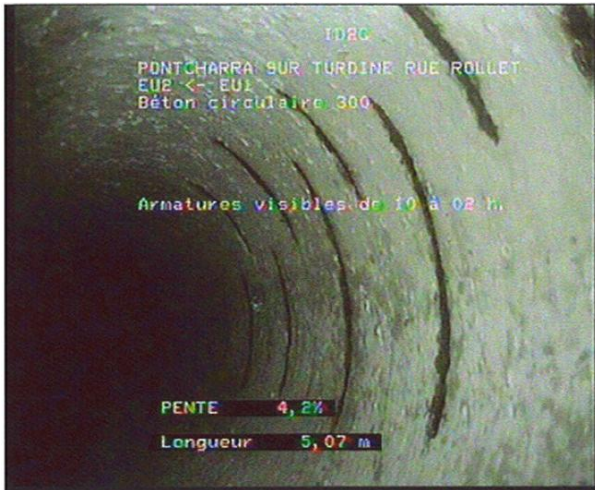
Armatures visibles, Rue Rollet, Pontcharra-sur-Turdine
