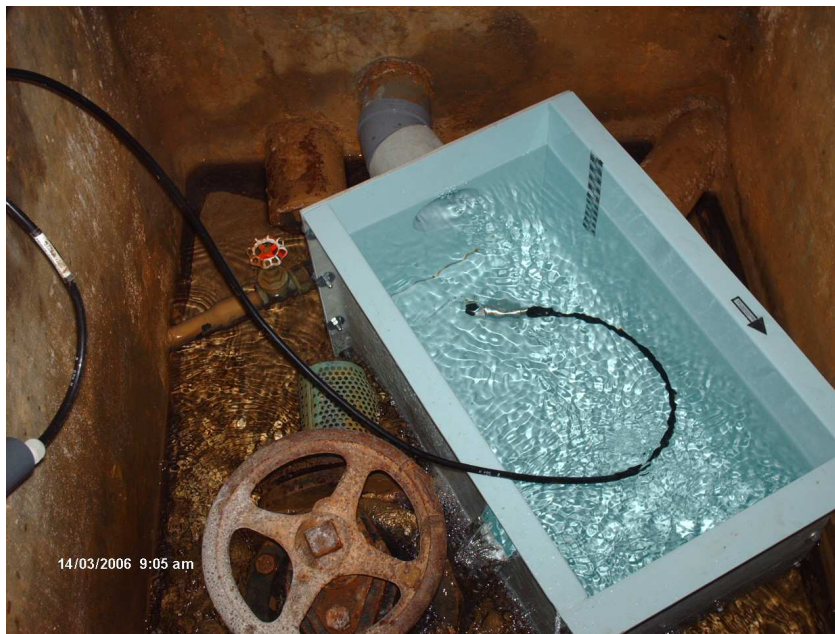
Exemple de débitmétrerie avec enregistrement dans un captage
