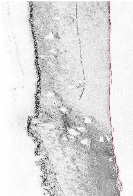
Image du Sonar Latéral en cascade, enregistré en temps réel, qui montre les voitures dans le canal.
