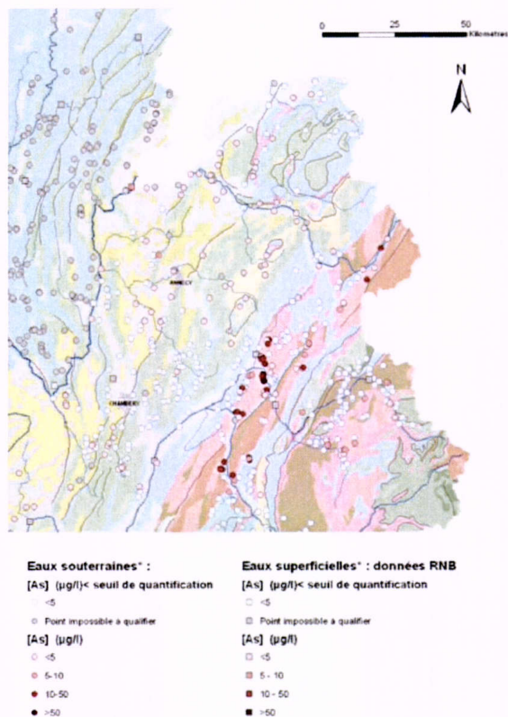
Illustration 3 : Variabilité des limites de quantification dans les eaux souterraines et les eaux de surface.
