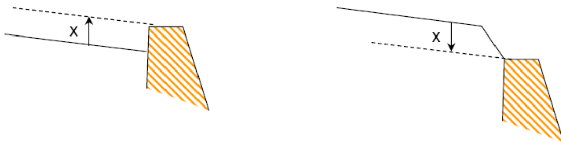
Figure 1 : effet de pelle : seuil plus large que la rivière, pelle positive (a) - seuil plus étroit que la rivière, pelle négative (b)
