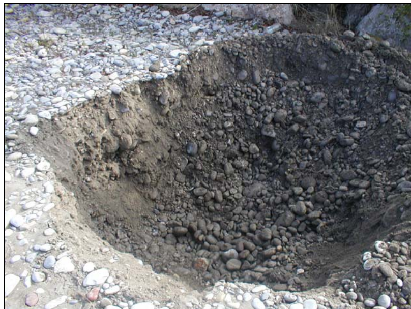
Prélèvements de matériaux à 1 m de profondeur environ
