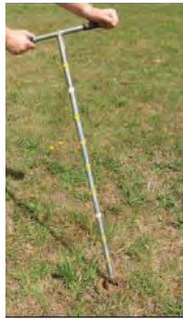
A. Après avoir dégagé la surface du sol, si nécessaire, prélever l'intégralité de la première carotte dans la tête de la tarière.
