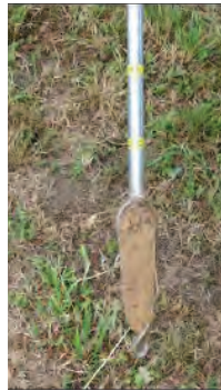
B. Lorsque la tête de la tarière est remplie, cela correspond à n'avancement de 20 cm.
