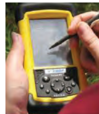
I. On enregistre la position géographique du point à l'aide d'un GPS (le cas échéant, le repérer sur une carte IGN au 1/25 000).
