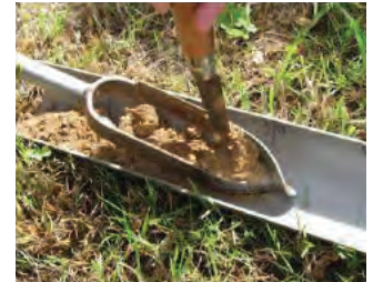
G. Déposer de nouveau la carotte dans la gouttière.
