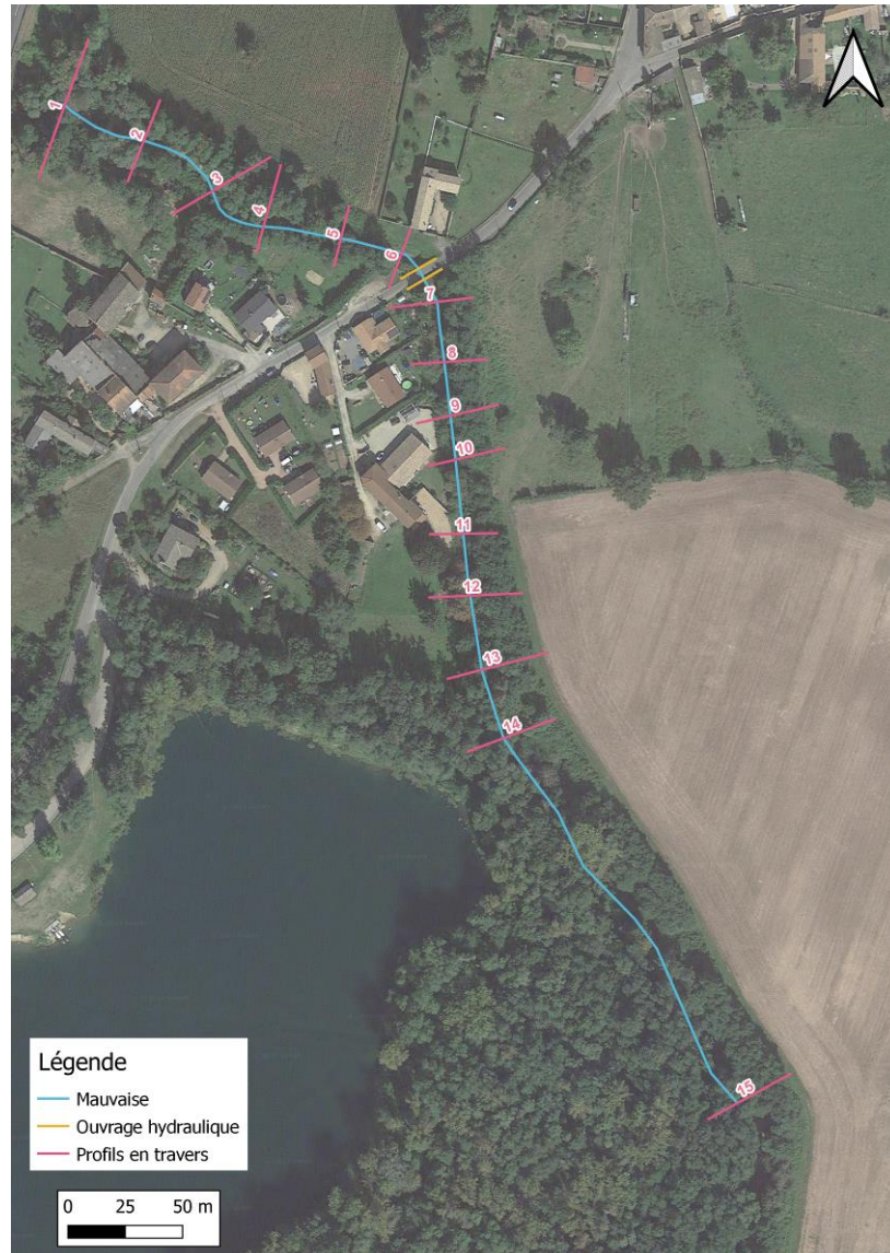
Figure 38 : Synoptique du modèle hydraulique réalisé
