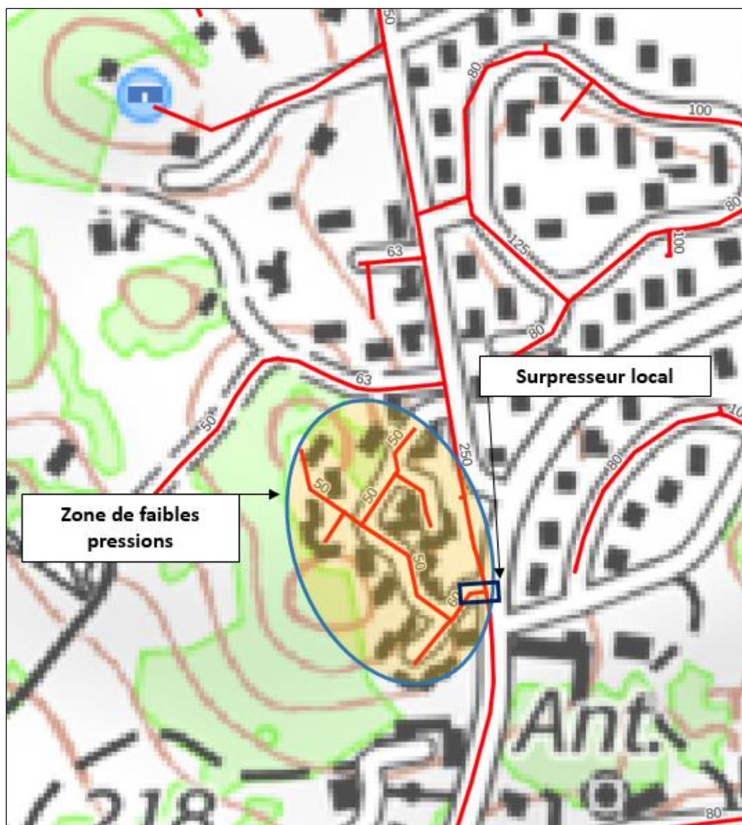
Figure 89 : Installation d'un poste de surpression, à proximité du réservoir au Sud
