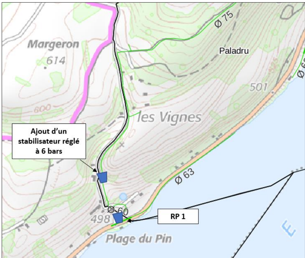
Figure 106 : Problématique C.6 / Déplacement de RP 1 et influence sur les pressions maximales
