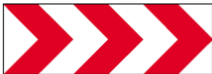
Barrières K 8 : la coupure se situe au niveau d'un carrefour en "T". Il faut orienter correctement les pointes du K8.
