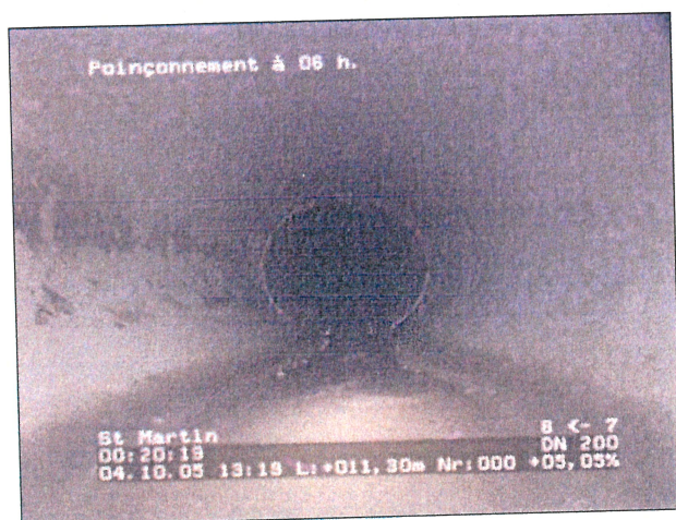
Photo: 5_4a, N° cassette: 1, 00:20:16 11,3m, Poinçonnement à 06 h.
