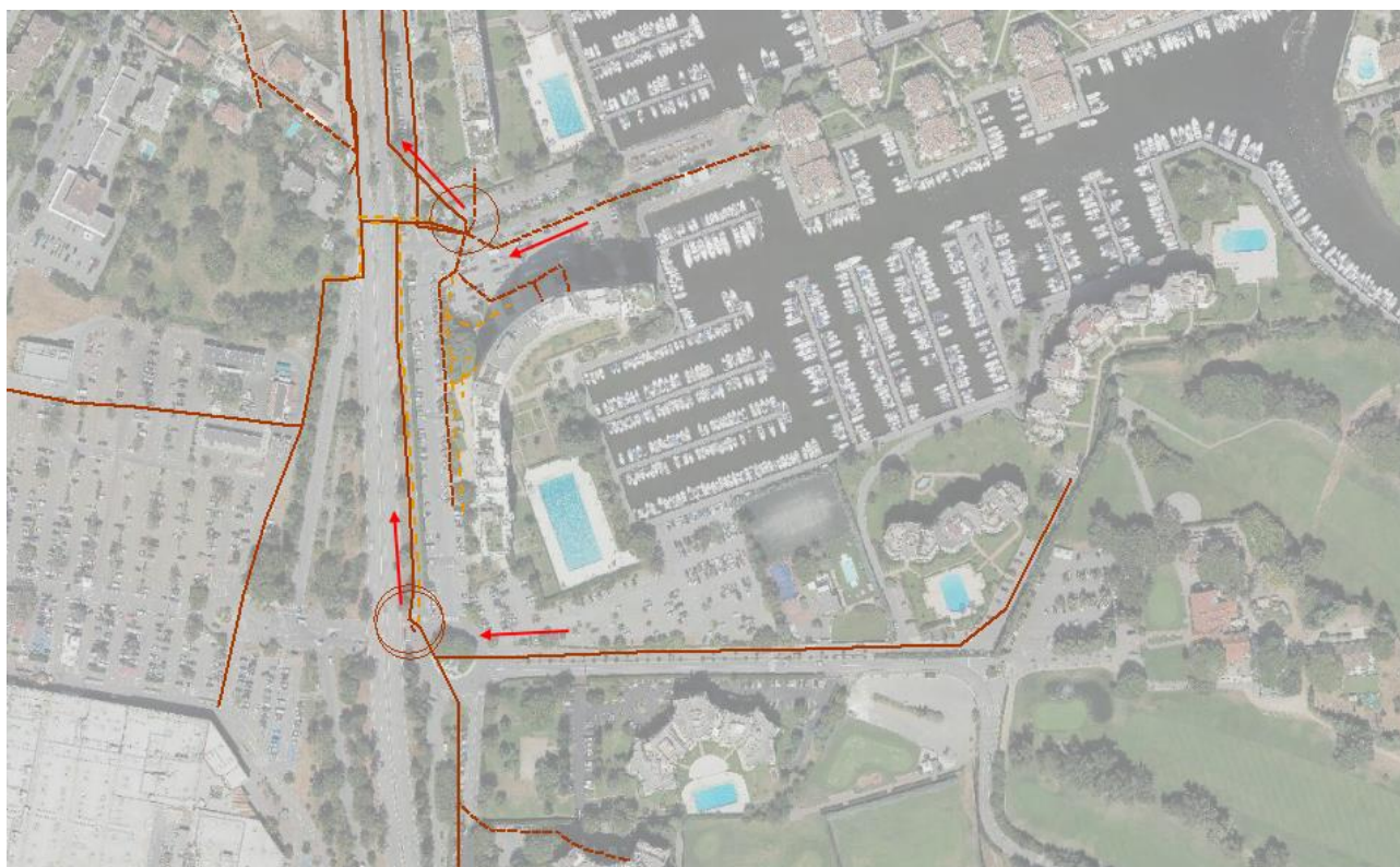
Figure 6937 : réseau d'eaux usées Postes de relevage : cercles
