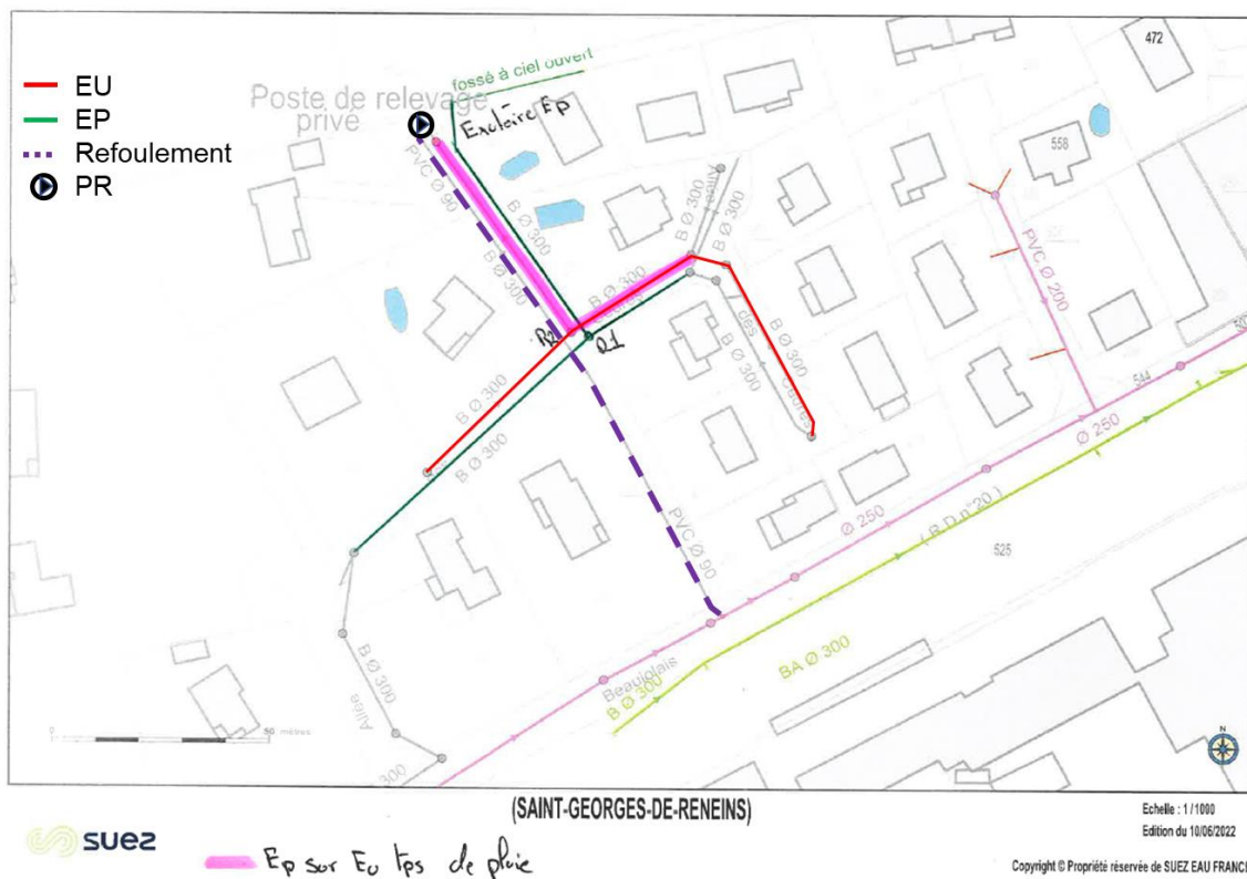
Figure 11 : Réseaux privés de l'Allée des Cèdres
