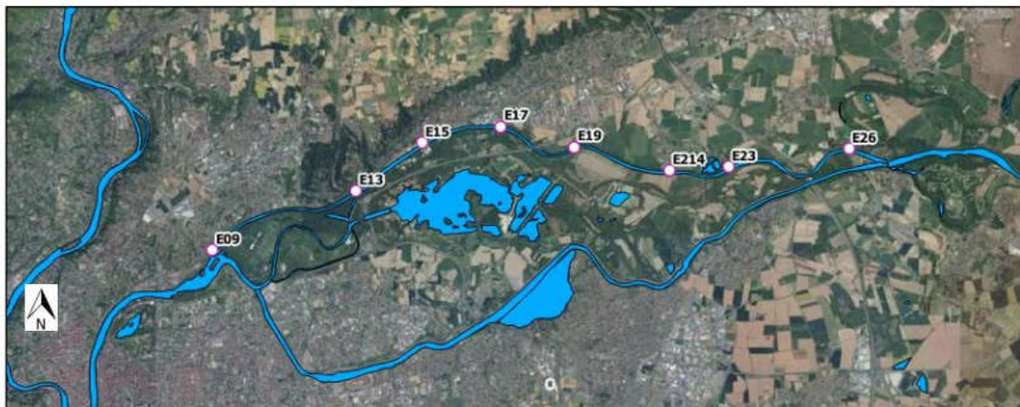
Figure 4-6 : position des échelles limnimétriques sur le Rhône de Miribel
