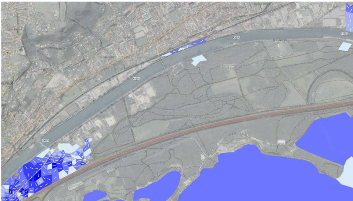
Figure 4-10 : extrait résultats modèles Hydra – Q = 1960 \text{ m}^3/\text{s} t = 137\text{h} sur l'hydrogramme modélisé
